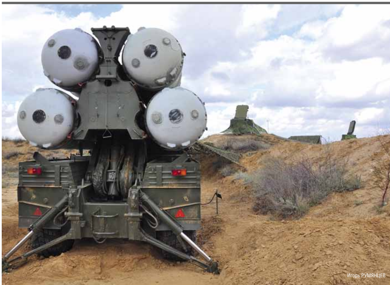
▼ В составе зрди С-400 до 12 транспортно-пусковых установок типа 5П85ТЕ2 и/или 5П85СЕ2 на прицепе
