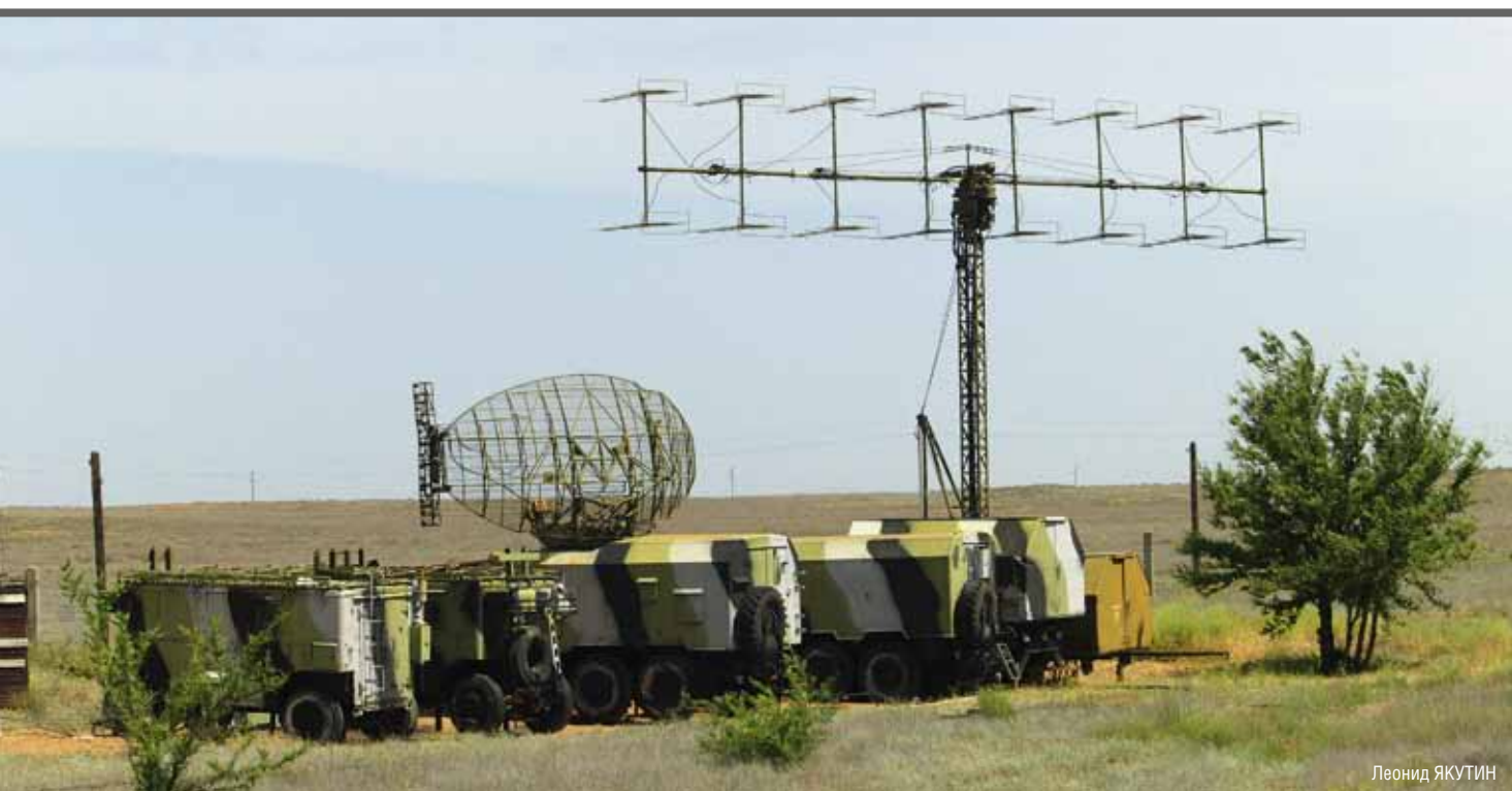
▼ П-18 «Терек» – мобильная двухкоординатная радиолокационная станция кругового обзора метрового диапазона волн
