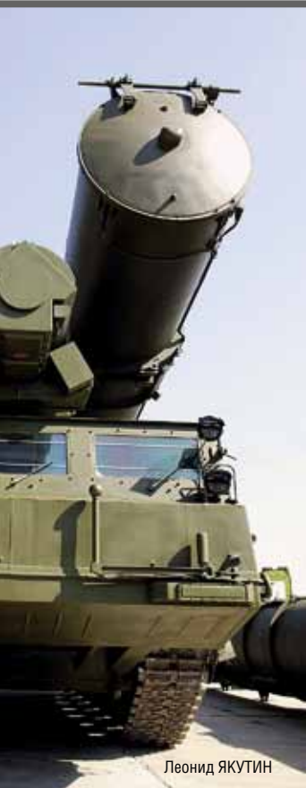
▼ Пусковая установка ЗРС С-300В 9А82М
